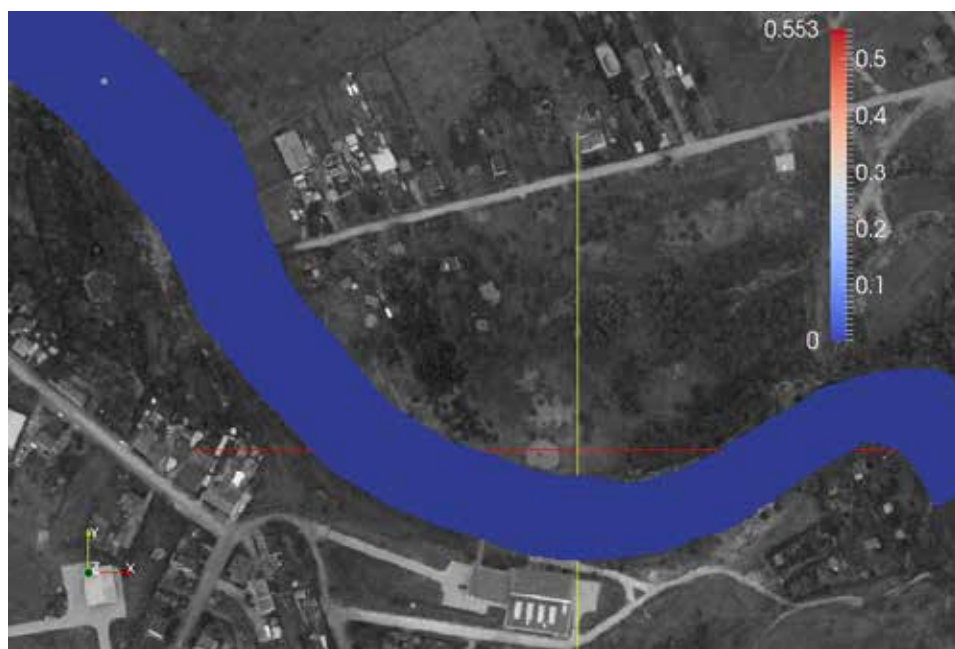
Ryc. 1. Uwolnienie paliwa w okolicach środka rzeki, stany wody średnie, czas symulacji: 0 s ( \text{dm}^3/\text{dm}^3 )
