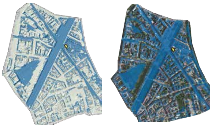
Ryc. 23. Analiza widoczności projektowanego wysokiego budynku. Po lewej – na podkładzie cieniowanego NMPT, po prawej – na podkładzie ortofotomapy
